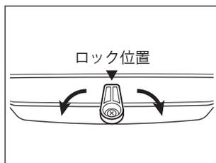
ストッパーを外して、ダストコンテナの取っ手に手をかけ、前方に引き上げるとダストコンテナが外れます。
