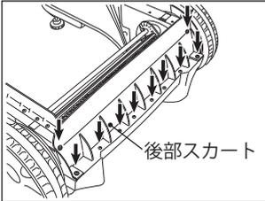
本体後部のスカートが傷んだり変形したりして、ゴミが外にもれるようになった場合に交換します。
