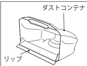
ダストコンテナのリップが傷ついたり変形したりして、ゴミの収集が悪くなった場合、交換します。
