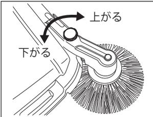
使用する場所に合わせてサイドブラシの高さを調整します。
