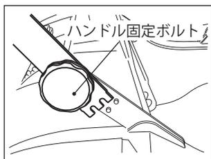
ハンドルをハンドル固定ボルトで固定します。ハンドルの溝を差し込む位置によってハンドルの角度を3段階に変えることができます。
